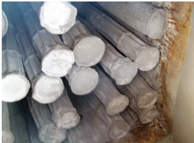
Figura 4 - Mangas saturadas e choque com estrutura metálica.
