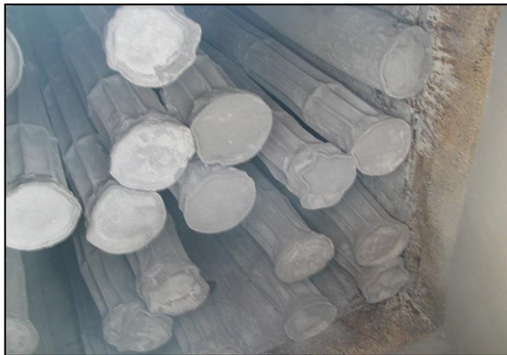
Figura 11 - Mangas saturadas e choque com estrutura metálica.
