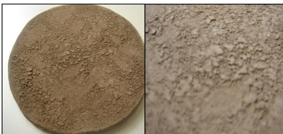
Figura 12 - Amostra com estrutura têxtil entupida.
