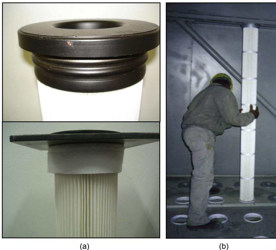
Figura 13 - (a) Fixação Top Loader; (b) Colocação de mangas plissadas no filtro.
