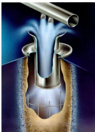
Figura 4 - Fluxo de ar comprimido no interior do venturi.
