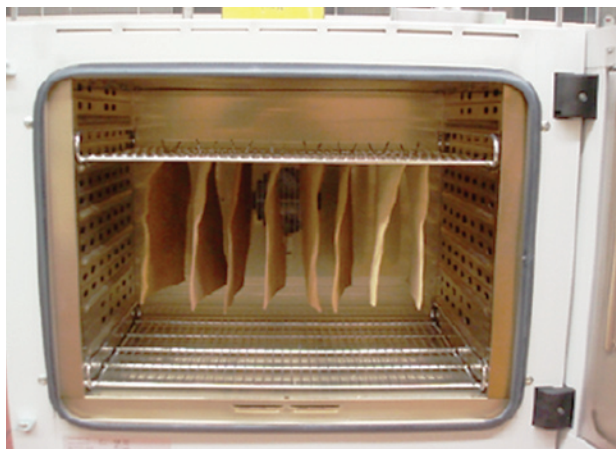
Figura 10 - Teste de oxidação e degradação acelerada em estufa
