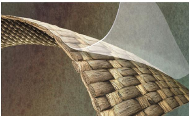
Figura 6 - Fibra de vidro com membrana PTFE expandida
