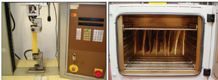
Figura 1 - Dinamômetro com amostra de P84
